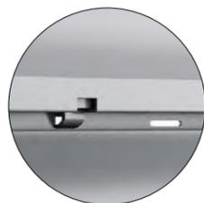
L'avvolgibile in pvc **Mignon** (peso specif. standard di ca. kg. 3,300/mq) è realizzato con stecche auto-aggiacianti (a doppia parete e con intersezioni di irrigidimento interni) che misurano 9 mm di base e 38 mm di altezza. Il profilo è dotato di un fermo laterale "antisfilamento" che serve a bloccare le stecche. Questa tipologia di avvolgibili rispetta i requisiti previsti dalla normativa UNI EN 13659:2009.
