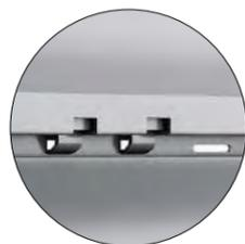
L'avvolgibile in PVC rinforzato SOLE 5 (peso specifico standard di circa kg 5,000/mq) è realizzato con stecche auto-aggancianti (a doppia parete, con intersezioni di irrigidimento interni e rinforzi in resina) che misurano 13 mm di base e 55 mm di altezza. Il profilo è dotato di fermo laterale "antisfilamento" che serve a bloccare le stecche.
