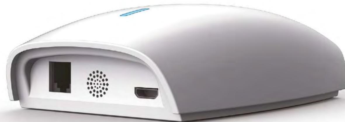
Il ponte connettore consente all'utente di collegare le proprie tapparelle motorizzate, persiane e tende alla rete Wi-Fi, consentendo il controllo tramite APP e l'interazione con altri prodotti IoT.
