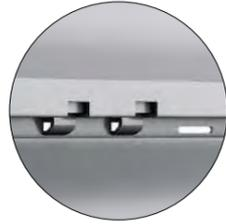
L'avvolgibile in PVC rinforzato SOLE 4,5 (peso specifico standard di circa kg 4,500/mq) è realizzato con stecche auto-aggancianti (a doppia parete, con intersezioni di irrigidimento interni e rinforzi in resina) che misurano 13 mm di base e 55 mm di altezza. Il profilo è dotato di fermo laterale "antisfilamento" che serve a bloccare le stecche.
